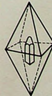
Bild 3. In dieser Richtung muß eine Diamantspitze aus dem Rohkristall herausgeschliffen werden
